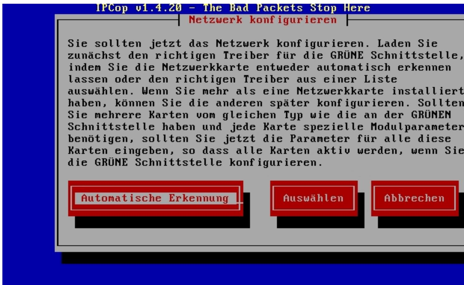
Hier wird die Hardwareerkennung gestartet. Zuerst wird nur die "erste Netzwerkkarte" (die für das interne Netz) eingebunden.
