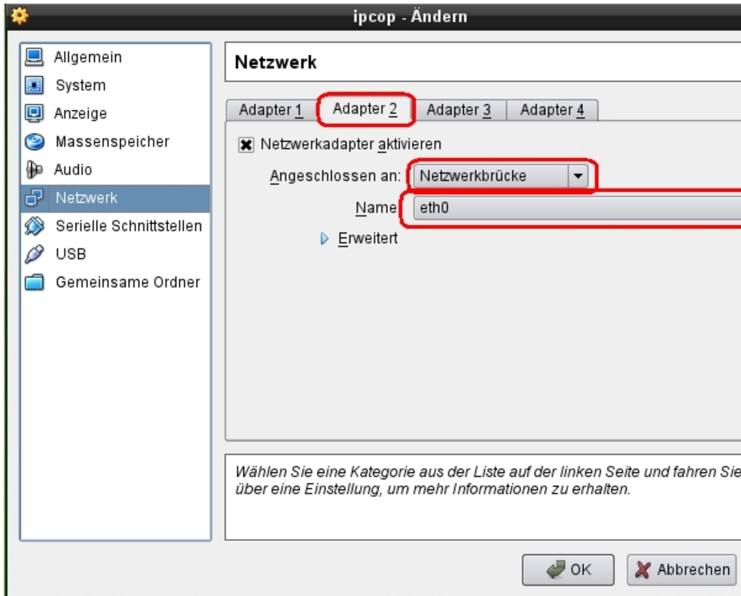
Hier wird die Zweite Netzwerkkarte konfiguriert. In der Einstellung "Netzwerkbrücke" werden die Datenpakete direkt an die Netzwerkkarte durchgereicht.
