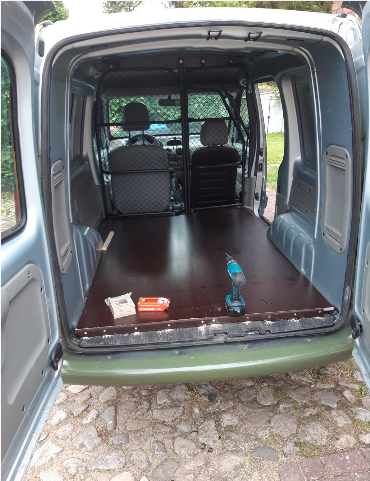
Die Gittertür ist durch Metallstreifen über das Fahrzeug mit dem Fahrzeugaufbau verschraubt sein, [hier](#)
